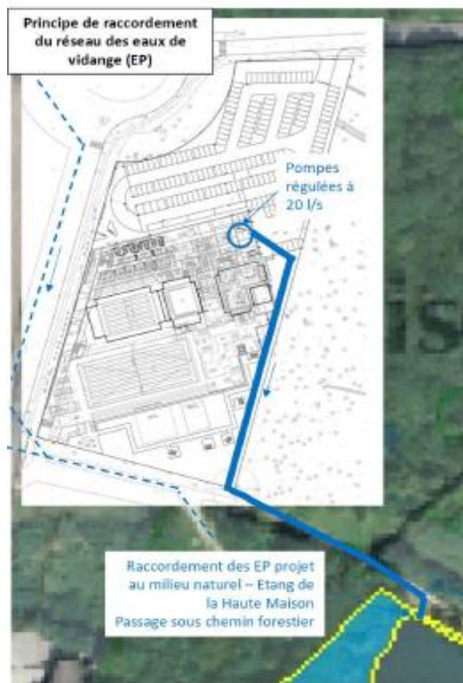
Principe de raccordement du réseau des eaux de vidanges – Source : DLE
