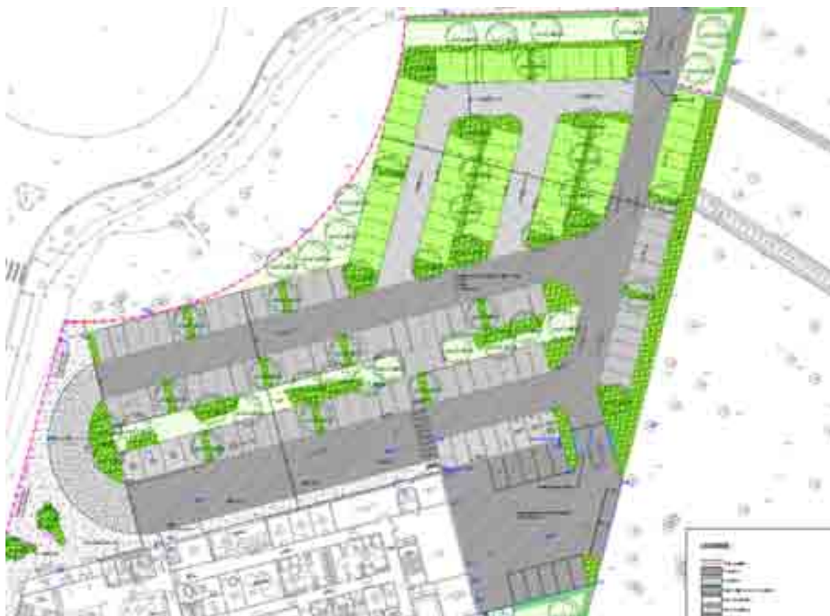
Répartition des places de stationnement imperméabilisées (en gris)/ engazonnées (en vert) – Source : APS
