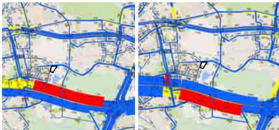
Simulations de trafic horizon 2015 réalisée par CDVIA (heure de pointe matin à gauche, soir à droite)
