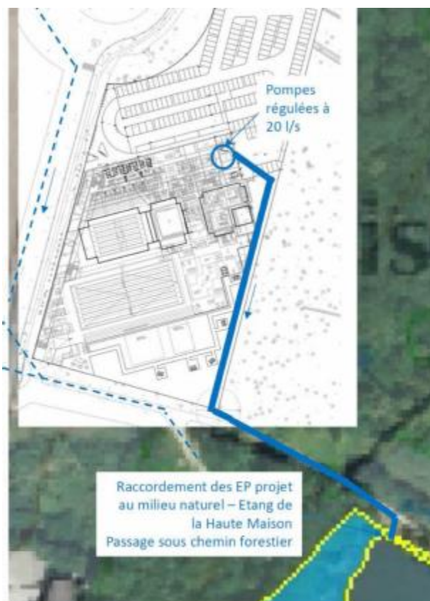
Principe de rejet des eaux de vidange des bassins – Source : DLE
