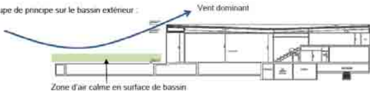
Schéma de principe de protection des plages extérieures aux vents dominants à Champs-sur-Marne- Source : APS
