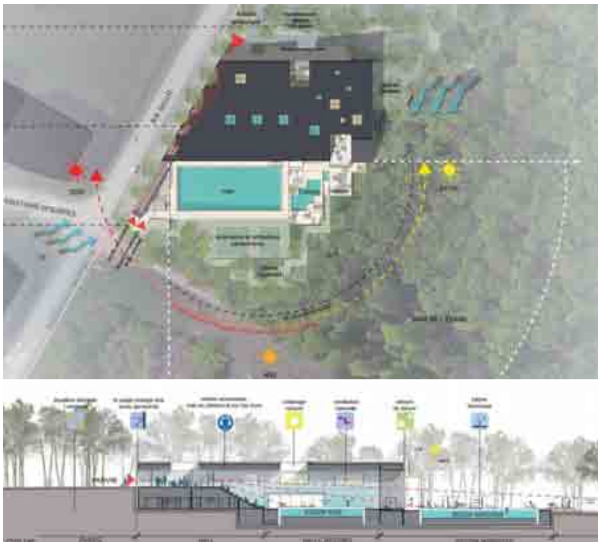
Intégration des principes bioclimatiques à l'architecture du centre aquatique
